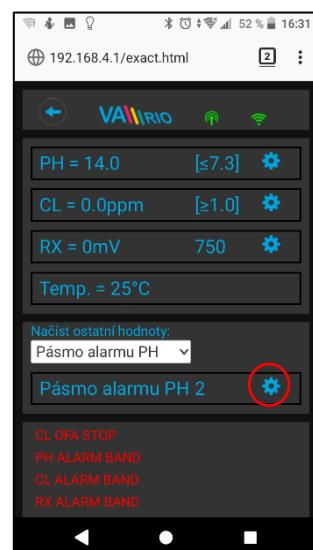
Navedene izmjene i postavke vrijede za parametre pH. Na isti način izvršiti izmjene željenih vrijednosti ili statusa alarma za parametre klor (CL), odnosno redoks (RX). Zadana lozinka za izmjene je "1234".
