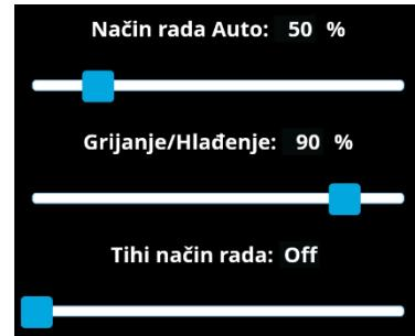
**TIHI način filtriranja** – Način takozvanog „tihog rada“ – u postavljenom intervalu neće se uključiti ni filtriranje ni grijanje. Noći način rada nema utjecaja na vremensku sklopku za osvjetljenje ili atrakcije.
