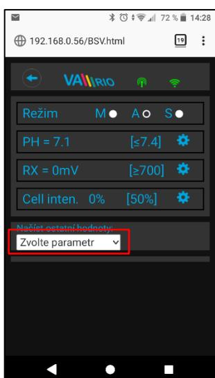
Klepnutím na ikonu aktivujete náhled jak parametrů jakosti vody (pH/RX/FCL/teplota/salinita v závislosti na typu připojené sondy), tak případně v alarmové stavu a provozní parametry úpravny slané vody (tzv. "solničky").
