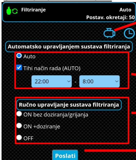
**Okretaji pumpe** – podešavanje okretaja motora pri raznim načinima rada filtracije. Samo s modulom DIN PUMPE.
