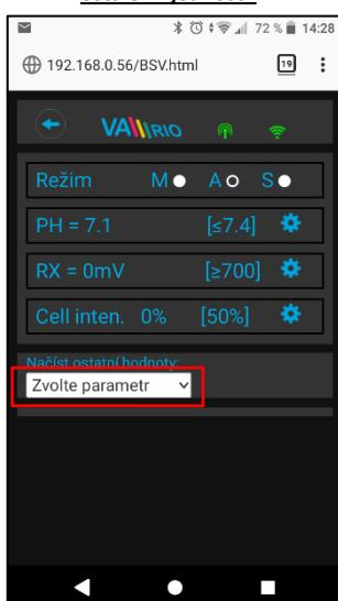
Pritisom na ikonu aktivirate prikaz parametara kvalitete vode (pH/RX/FCL/temperatura/salinitet u ovisnosti od vrste spojene sonde), kao i status alarma i radne parametre pročistača slane vode (klorinatora).
