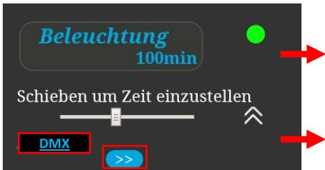
Die Schaltfläche **DMX** öffnet das Menü mit den erweiterten Einstellungen für DMX-Lichter.
